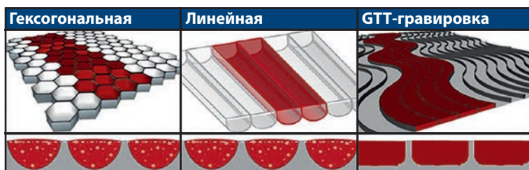
Рис. 6. Виды гравировки анилоксовых валов.
