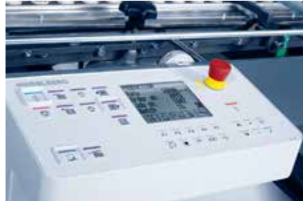
可通過控制台從飛達及其他工作站上進行快速調節。
