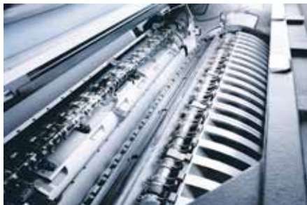
W pełni automatycznie przestawiane urządzenie do odwracania arkuszy dla idealnego pasowania również przy najwyższych prędkościach.
