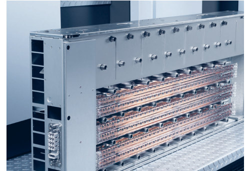
Optymalny montaż lamp promienników podczerwieni w module DryStar.
