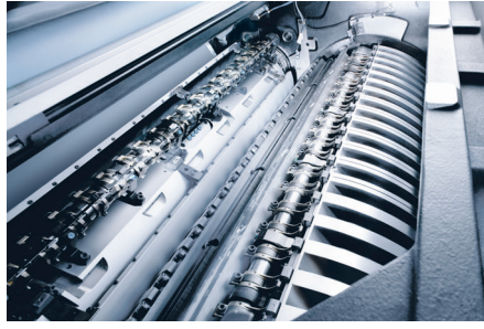
최고 속도에서도 정확한 핀맞춤을 위해 완전 자동으로 조절되는 양면 장치
