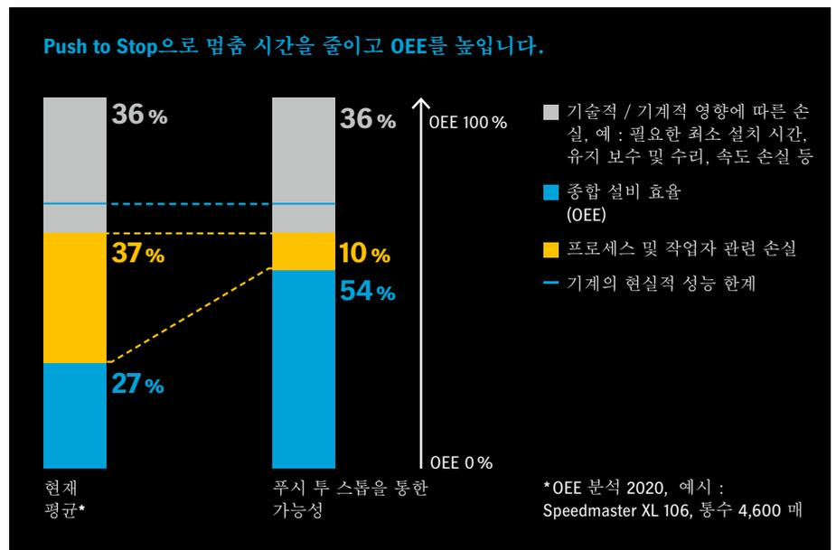
**잠재력 활용 : 황색 막대에 집중한다.** 기계의 OEE를 높이려면 잠재력을 활성화해야 합니다. 이 잠재력의 약 절반은 기술적인 측면 (그림의 회색 막대)과 관련이 있습니다. 그러나 기술적 개선이 반드시 성공으로 이어지는 않으며 조직적 측면이 동시에 개선되는 경우에만 가능합니다. 잠재력의 나머지 절반은 프로세스 및 작업자와 관련이 있습니다 (그림의 황색 막대). 이것이 하이델베르크가 집중하는 부분입니다.
