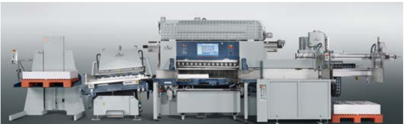
POLAR CuttingSystem 200 PACE: 고도로 자동화된 재단 시스템으로 1명의 작업자가 60분에 최대 45연까지 작업할 수 있습니다.
