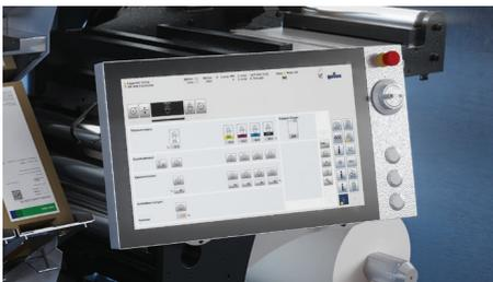
**Human Machine Interface (HMI)**는 중요한 정보를 한눈에 요약할 수 있도록 설계되었습니다. 품질 보증을 위해, 인쇄 결과를 실시간, 웹 비디오 또는 인쇄기가 작동하는 동안 확인할 수 있습니다.
