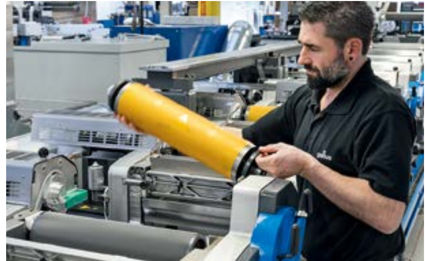
새롭게 개발된 갈루스 라벨마스터의 플렉소 인쇄 유니트에서는 매우 빠르게 실린더 교체를 할 수 있어 몇 초안에 작업 교환이 가능합니다.
