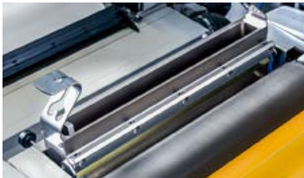
잉크 챔버는 빠른 인쇄 속도에 맞도록 설계되었습니다. 따라서 거품 형성을 줄이고 아니록스 롤러로 최적의 잉크 전이를 보장합니다.
