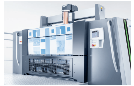
ブランケット／圧胴の洗浄と並行して刷版を同時交換するオートプレートXL3。
