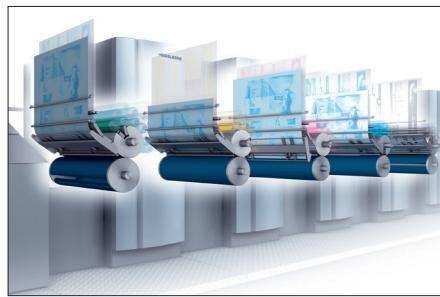
刷版を全自動で順次交換するオートプレートプロ。簡単で迅速な刷版交換で前準備時間を短縮。
