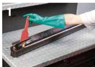
1 ドクターユニットを印刷機から取り出し、インキヘラで、ライナーをブレードからはずします。
