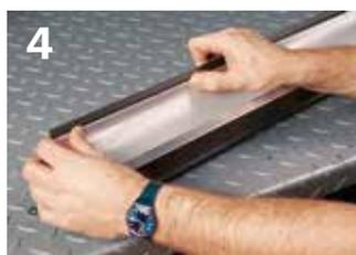
4 ライナーの端をブレードの溝に押し込み固定します。あとはドクターユニットを印刷機に戻すだけです。
