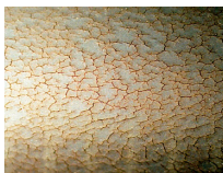
ózon által okozott repedések
