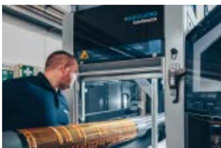
**Intellimatch**, el exclusivo escáner de planchas y manguitos de impresión fuera de línea ofrece todos los parámetros de imprenta para la Boardmaster.
