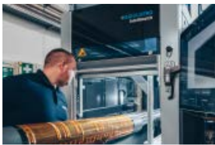
Intellimatch , der einzigartige Offline-Scanner für Druckplatten und Sleeves, liefert alle Einstellungsparameter für die Boardmaster.
