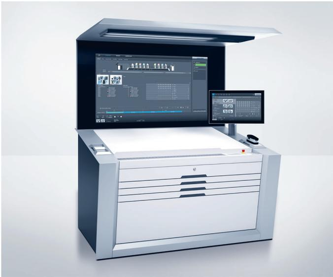
Un environnement de travail moderne sur le Prinect Press Center XL 3 avec écran 24" tactile multipoint et lampe de contrôle des couleurs à LED pour une adaptation optimale de la feuille.
