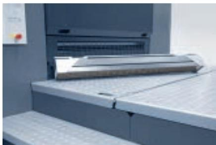
Heidelberg DryStar LED Pro : la nouvelle génération de sècheurs à LED ultra-performants offrant d'excellents résultats de séchage.
