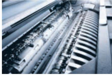
Dispositif de retournement à repositionnement entièrement automatique pour un registre de retournement précis, même à des vitesses de pointe.
