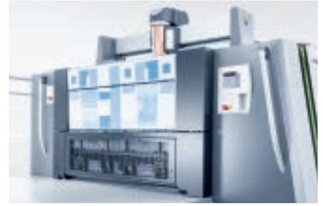
Changement de plaques simultané avec AutoPlate XL 3 en même temps que le lavage des cylindres porte-blanchet et des cylindres d'impression.
