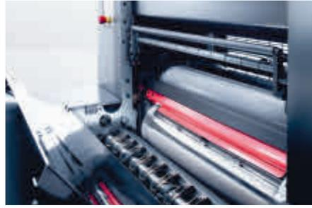
Le groupe de vernissage convient à différents vernis, pour des vernissages de protection sur toute la surface, des vernissages avec réserves, des vernis UV et des vernis spéciaux.
