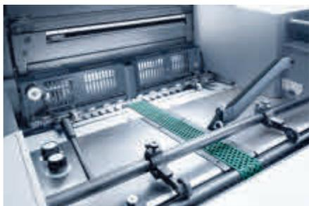
Le margeur pourvu d'une bande d'aspiration centrale est garant de la productivité et d'un transport optimal des feuilles dès le départ.
