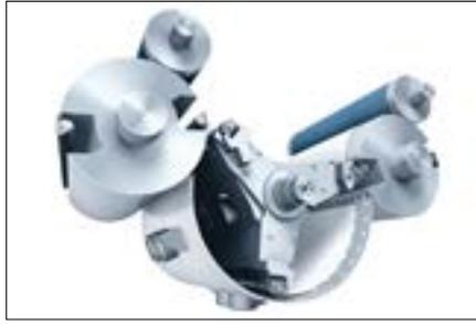
Système AirTransfer permettant un transport des feuilles sans contact sur un matelas d'air, en ne laissant ni marques, ni rayures.
