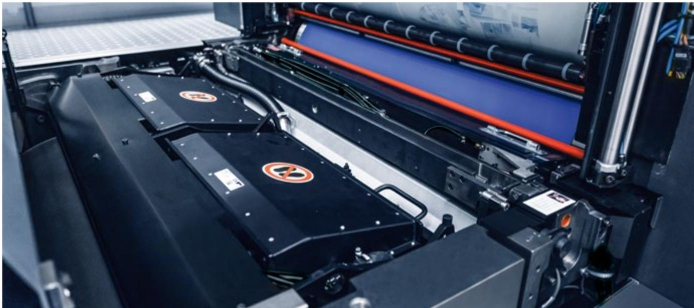
Le système intégré d'inspection des feuilles en ligne Prinect Inspection Control 4 détecte de manière fiable les plus petits défauts d'impression et de matériaux. À cette fin, les feuilles imprimées sont comparées en permanence à une valeur de référence numérique. Le guidage optimal de la tôle permet une inspection complète jusqu'au bord de fuite de la tôle.
