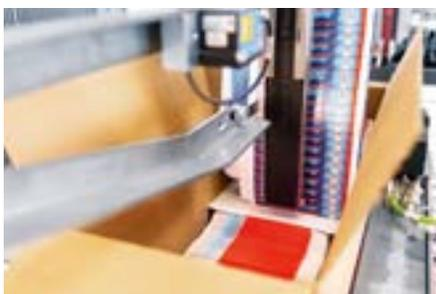
L'interface de la machine permet de sélectionner **des schémas de conditionnement** dans la caisse en carton de 1 à 4 rangées et niveaux.
