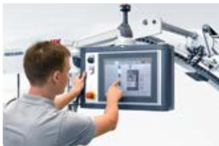
L'**ACC** définit le meilleur schéma de mise en caisse afin de superposer plusieurs niveaux et rangées en fonction des dimensions des boîtes pliantes et du carton d'expédition.
