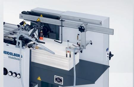
Le **margeur à piles plates** avec séparateur de feuilles permet une séparation fiable des feuilles.
