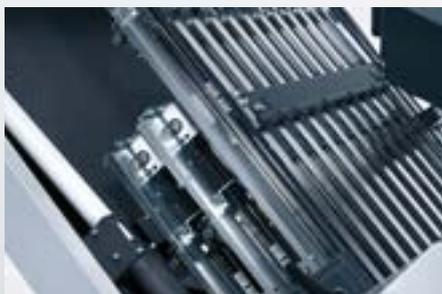
Les **poches de pliage mixtes automatique** permet un positionnement précis de la butée de la feuille.
