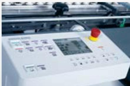
Le **panneau de contrôle MCT** permet une intervention rapide grâce à des panneaux de contrôle installés sur le margeur et les stations successives.
