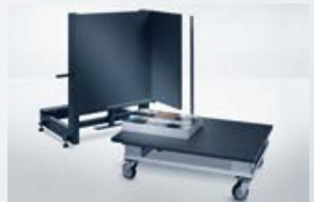
Pendant la production, le **dispositif de préempilage** permet le chargement parallèle du plateau de pile mobile.
