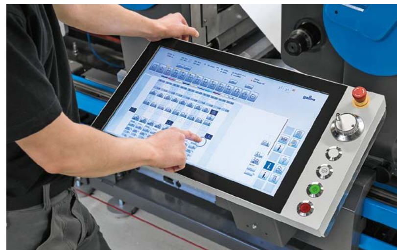
L'écran tactile HMI intuitif est organisé de façon claire et atteste de la simplicité d'utilisation de la Gallus Labelmaster.
