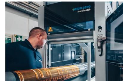
**Intellimatch**, le scanner de plaques d'impression et de manchons hors ligne unique en son genre fournit tous les paramètres nécessaires à la presse Boardmaster.
