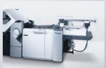
El **marcador de pila plana FFH** con **Tremat** garantiza una separación fiable de los pliegues.
