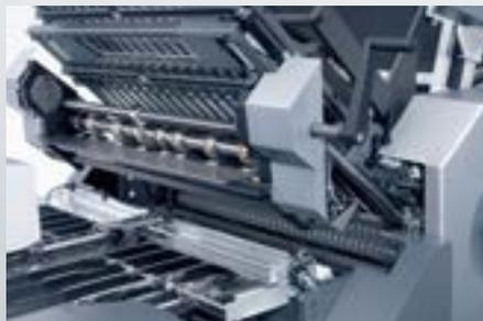
El **kit de elevación** permite una buena accesibilidad a los **árboles portacuchillas** montados en la parte trasera.
