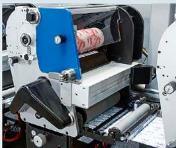
I gruppi di stampa con servo-azionamento permettono la massima flessibilità del substrato (anche laminati per tubetti).
