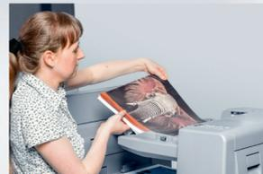
**El intercalador** introduce pliegos preproducidos en la pila durante la producción de impresión en curso, para una postimpresión continua en línea.
