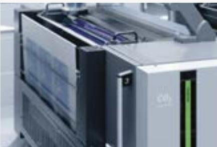
**AutoPlate Pro** steht für den voll-automatischen, bedienerunabhängigen und schnellen, gestaffelten Plattenwechsel.
