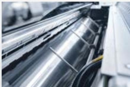
**Prinect Inpress Control 3** misst spektral und steuert die Farbe sowie das Register inline während der Produktion.
