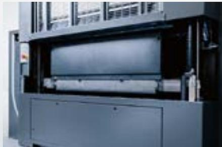
**Prinect Inspection Control 4** prüft jeden Bogen inline mit hochauflösenden Farbkameras auf Fehler, bevor Folgekosten entstehen.
