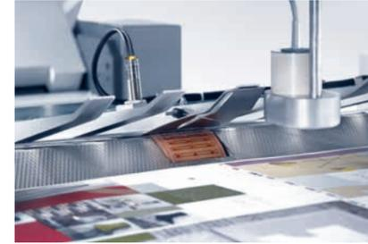
Unten liegendes Saugrad ermöglicht geschuppte Bogenzuführung.
