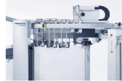
Stabile Bogenzuführung durch zweistufige Beschleunigung mit dem PFX Palettenanleger.
