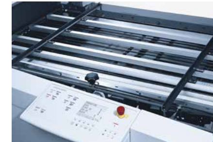
Zentrales Bedienfeld und AirstreamTable mit Prismenlineal zur exakten Ausrichtung der Bogen.
