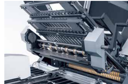
Einfache Zugänglichkeit der nachgelagerten Messerwellen mit dem Liftkit.
