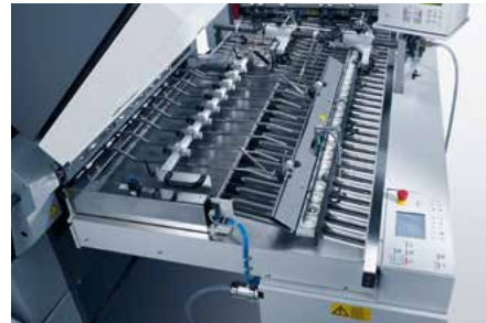
Mit der pneumatischen Doppelstromweiche Doppelnutzen verarbeiten.
