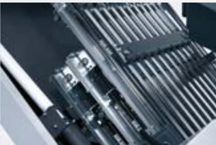
Die **motorischen Kombifalztaschen** ermöglichen ein präzises Positionieren des Bogenanschlags.
