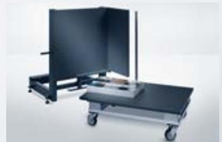
Während der Produktion ermöglicht die **Vorstapeleinrichtung** die parallele Beschickung eines mobilen Stapeltisches.
