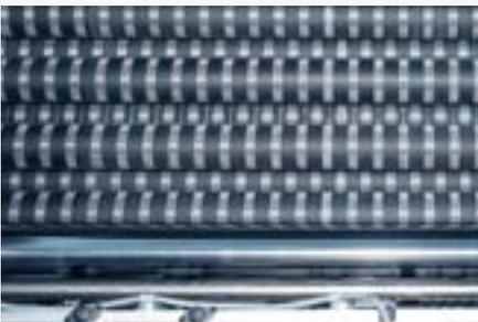
Die **Perfect Grip Falzwalzen** sind wartungsarm, fehlerverzeihend und sorgen für hervorragende Falzergebnisse.
