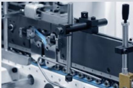
Die modulare **Faltbodenstation** besitzt ein Überholwellensystem mit Servoantrieb, sodass die FB II Bestfold flexibel an spezifische Anforderungen angepasst werden kann.
