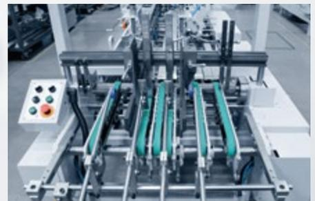
Der Vibrationsmotor sorgt für gleichmäßigen **Einzug**, während Stellzungen und Zusatzkomponenten einen präzisen und reibungslosen Betrieb gewährleisten.
