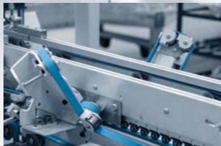
Der lange **Vorbrecher** erzielt einen 180°-Vorbruch an Rilllinie 1 und einen 135°-Vorbruch an Rilllinie 3 und bietet zahlreiche Möglichkeiten zur Implementierung von Faltelementen.
