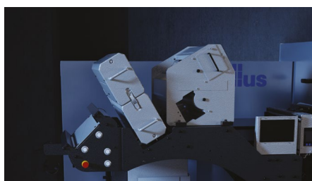
Automatische Spleisserkennung: Sensoren erkennen Spleisse auf der Materialbahn, sodass diese ohne Beeinträchtigung des Registers und bei voller Geschwindigkeit die Druckköpfe passieren können.
