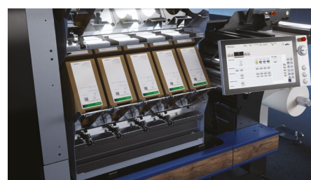
Optimiertes Tintenmanagement: Das neu entwickelte Tintenmanagementsystem erleichtert den schnellen und sicheren Tintencontainerwechsel ohne Kontaminationsgefahr.
