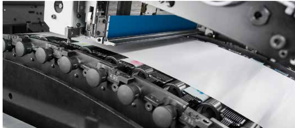
Die einzigartige rhombische Kopfform erleichtert das nahtlose Aufeinanderfügen der Köpfe zu einem Farbbalken.
