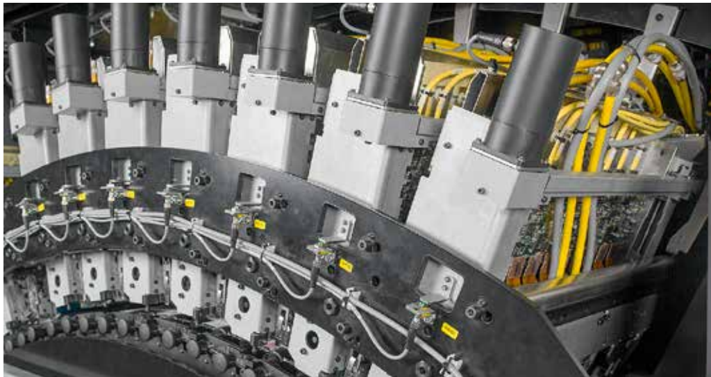
Achtfarbig angelegtes Drucksystem für eine maximale Farbraumabdeckung.
