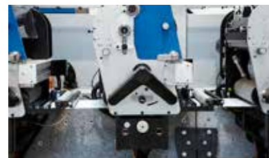
Der kurze Bahnlauf von nur 1.1 m für tiefste Makulaturwerte und damit höchste Rentabilität.
