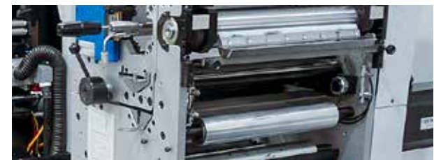
Einfach und zuverlässig: das servoangetriebene Siebdruckwerk.
