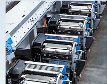
Ein extrem kurzer Bahnlauf reduziert die Makulatur.
