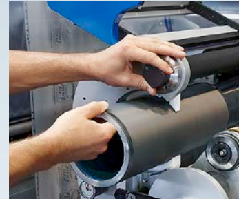
Die Frontbeladung für Anilox-Sleeves ermöglicht einen schnellen und einfachen Wechsel.
