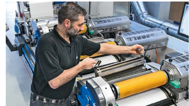
Mit nur wenigen Handgriffen lässt sich die Farbkammer bequem wechseln.
