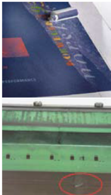
Schichten oder Lagen können sich durch verschiedene Bewegungsvorgänge im Stapel bis zu 15-mal aufrollen. Dies führt zu den genannten Aufrollern, Aufschälern usw. Laufen diese durch die Druckmaschine, kommt es zwangsläufig zur Beschädigung der Drucktücher, in drastischen Fällen können sogar noch weitere Aggregate Schaden nehmen.
