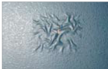
Abbildung 2: Ablösen der Maschinenlackierung nach Einwirken eines besonders aggressiven Waschmittels.
