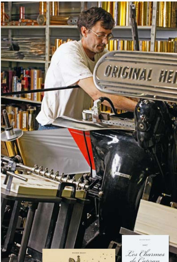
Etiquetten und Geschäftsunterlagen mit Goldprägung druckt Pujol mit einem umgerüsteten Tiegel. Die Maschine ist ununterbrochen im Einsatz, da immer mehr Weinproduzenten Wert auf hochwertig gestaltete Etiketten legen.
