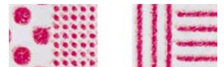
Schieben (oben) bzw. Doublieren (unten) z.B. durch falsche Aufzugshöhen, ungenügende Abwicklung und zu hohe Pressung.
