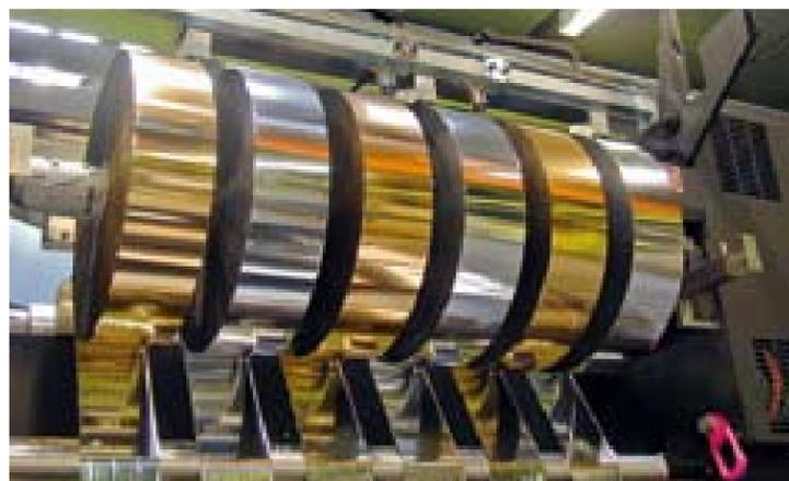
Einfach glänzend: Das weiterentwickelte FoilStar-Modul von Heidelberg kann bis zu sechs Folienbahnen verarbeiten und ist ab Herbst 2007 nicht nur für die Speedmaster CD 74 und die CD 102, sondern auch für die XL 105 verfügbar.
