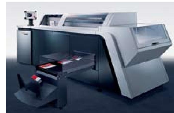
Ideal für kleinere und mittelständische Betriebe: Der neue 1-Zangen-Klebebinde Eurobind 600, der wie sein großer Bruder Eurobind 1300 entweder mit Hotmelt- oder PUR-Auftragstechnologie lieferbar ist.
