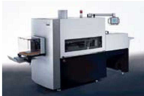
Extrem kurze Rüstzeiten: Der automatische Dreiseitenschneider Eurotrim 1000 für kleine bis mittlere Auflagenhöhen.
