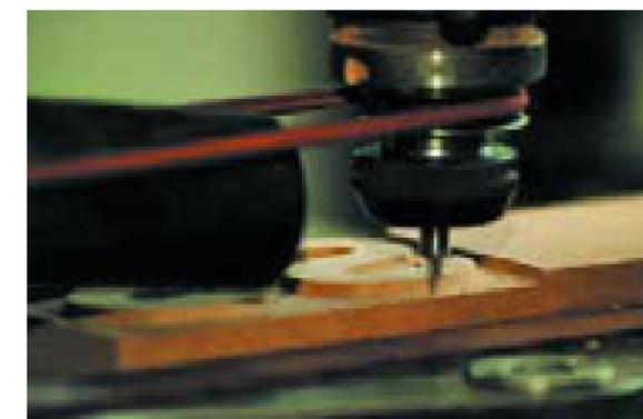
Durch das pantografische Gelenksystem der Holzletternfräse (Bild oben) überträgt Janssen die Form einer Buchstabenschablone verkleinert auf einen Holzblock (Bild unten).
