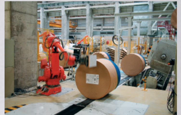
Vollautomatische Konfektionierung: In „handliche“ Stücke zerteilt, verpackt und etikettiert, geht es in ein Hochregallager oder den Versand.
