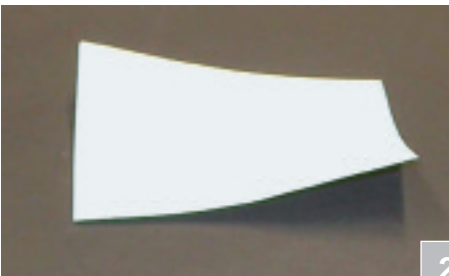
Hochstehende Ecken einer Papierprobe nach der Lagerung in einem Wärmeschränk.
