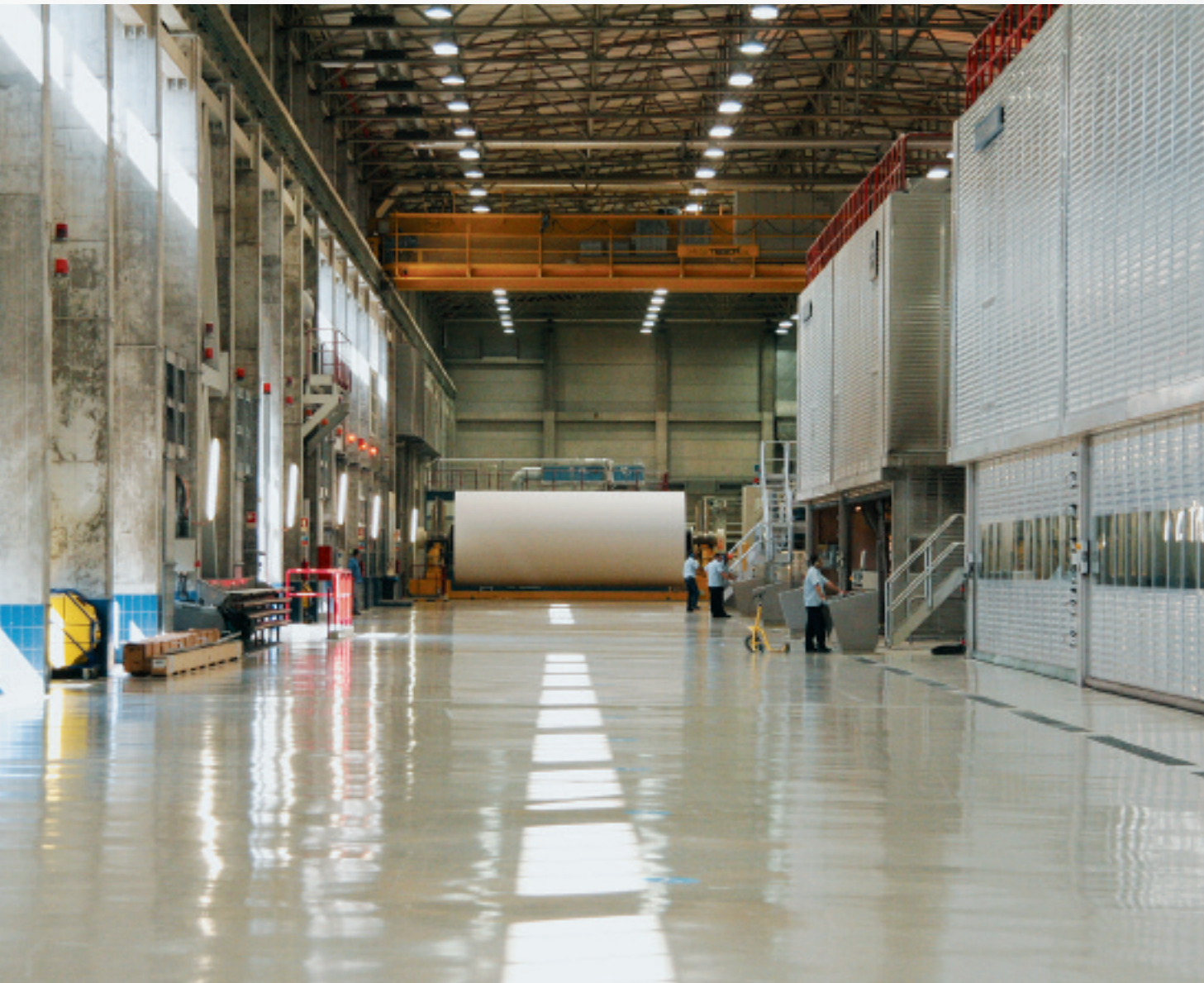
... mit bis zu 50 Tonnen Gesamtgewicht am Bahnende. Die 182 Meter lange Maschine produziert bis zu 1.500 Meter Papier in der Minute. Sie ist eine der beiden modernen Papiermaschinen in Figueira da Foz.
