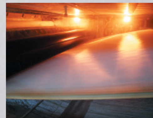
Nach wenigen Metern wird aus dem Papierbrei eine Papierbahn ...
