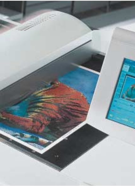
Prinect Image Control, ein Farbmess-System zur Qualitätskontrolle. Es sichert eine durchgängige Druckqualität auf einem konstanten Niveau.
