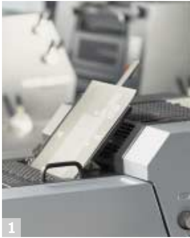
AutoPlate mit integriertem Register-system für beide Druckwerke.
