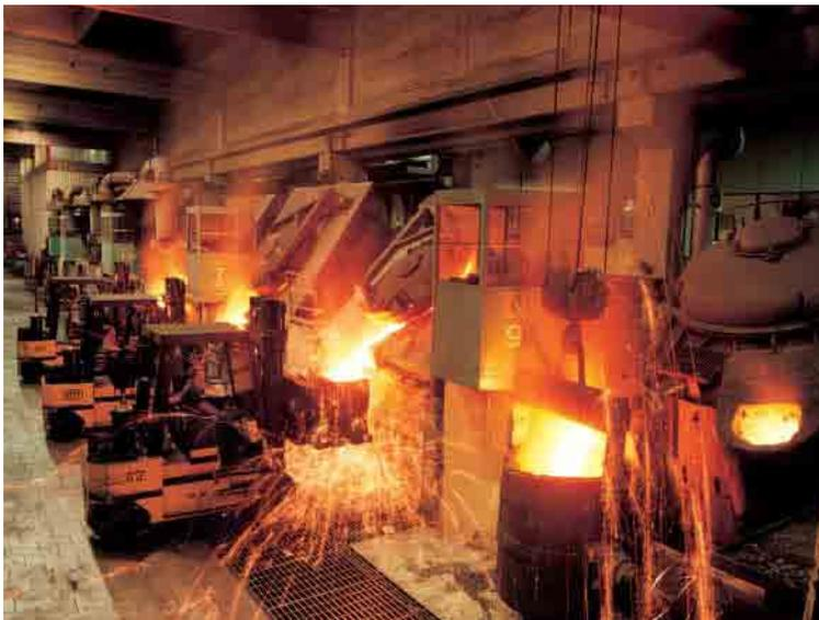
**Die Amstettener Gießerei entspricht den höchsten Umweltstandards. Hier wird zum Beispiel das Eisen elektrisch erschmolzen.**
