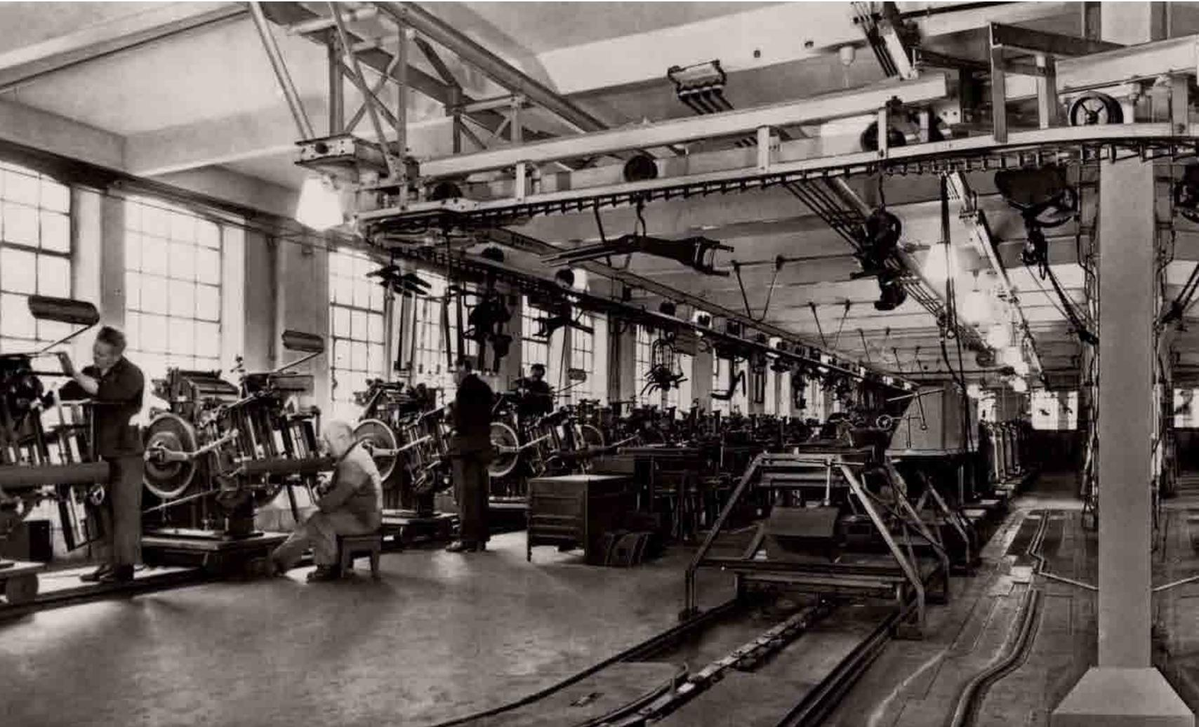
**„Tiegel“-Montage in Heidelberg: Auf zwei U-förmigen Fertigungsbändern bewegten sich die Maschinen zur Montage der Einzelteile durch die Halle. Von oben wurden die Klein- teile zugeführt.**
