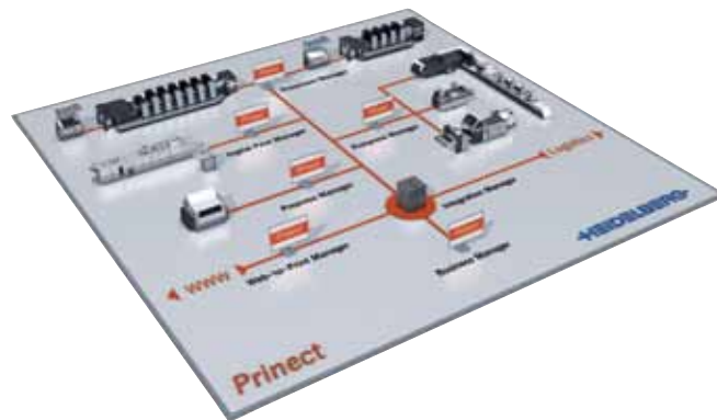
Prinect-kokonaisjärjestelmässä on omat Manager-ohjelmistonsa painon kaikkien tehtävien hallintaan. Eräsalon ratkaisu on toistaiseksi hiukan kaaviokuva suppeampi.
