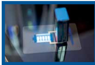
Painotekniikalla valmistetut OLED-täplät valaisevat kirkkaasti. OLEDin muoto voi olla lähes mikä tahansa.
