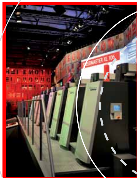
Heidelberg Speedmaster XL 106 on B1-formaatin tehotuotannon uusi lippulaiva. Huippunopeus on 18.000 kierrosta myös kääntölaiteajossa ja koneessa on lukuisia uusia piirteitä, jotka tekevät kuntoonlaitosta äärimmäisen nopean.
