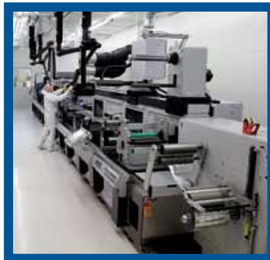
Heidelberg, BASF ja Darmstadtin tekninen yliopisto tekevät mm. painetun elektroniikan materiaalien ja painotekniikan kehitystyötä yhteisellä testipainokoneellaan
