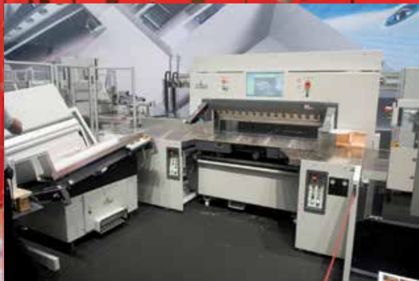
Polar-leikkuujärjestelmän kanssa työskentely on kevyttä ja sujuvaa. Kun pinohissi ja lavaaja huolehtivat paperipinojen nostosta ja lastusta, ei käyttäjän selkä rasitu.
