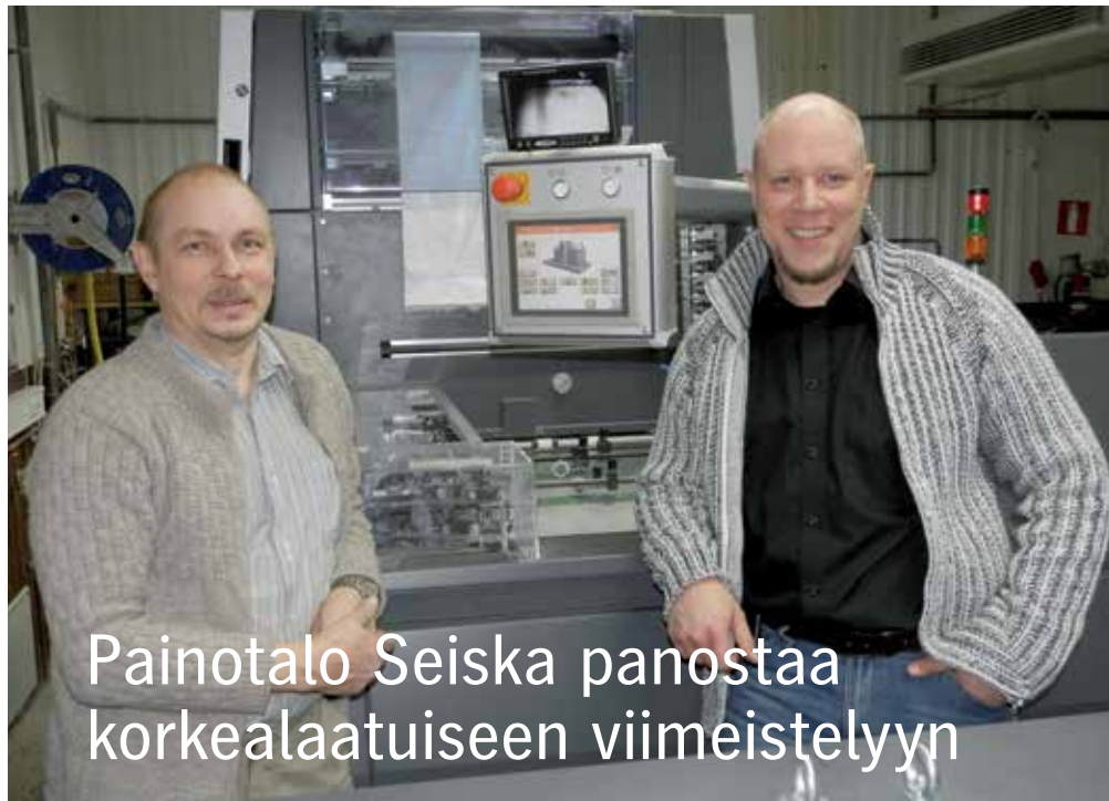
Kama ProCut 76 Foil stanssaa, nuuttaa, perforoi, preeglää ja kuumafolioi. Kone antaa painotalolle hyvän mahdollisuuden erikoistumiseen ja uusien asiakkaiden saamiseen.
