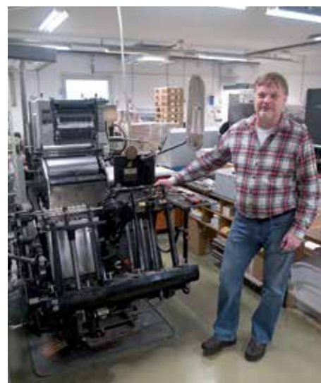
Jokaisesta kunnan kirjapainosta pitää löytyä ainakin yksi "Siipi-Heikku". Jarmo Hatakka esittelee vanhan koneen hienostunutta mekaniikkaa, jossa erilaiset epäkieskot ohjaavat tarkasti koneen toimintaa.
