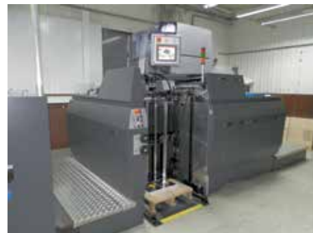
Kama ProCut 76 Foil stanssaa, nuuttaa, perforoi, preeglää ja kuumafolioi. Kone antaa painotalolle hyvän mahdollisuuden erikoistumiseen ja uusien asiakkaiden saamiseen.
