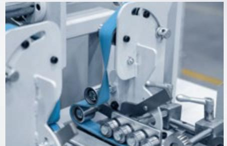
Las **bandas de plegado** ajustables mantienen una precisión constante y eliminan las desalineaciones, lo que garantiza resultados impecables incluso a altas velocidades.
