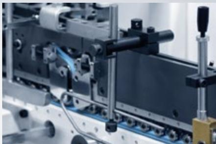
La **sección inferior de bloqueo** modular incluye un sistema de plegado trasero servoaccionado, que permite que la FB II Bestfold se adapte a los requisitos específicos del cliente.
