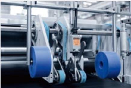
La **sección de entrega** cuenta con zonas de presión neumáticas ajustables y velocidad de banda regulable para diversos estilos de cajas y plegados en espiral.
